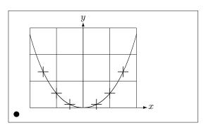
En esta figura, cada mitad simétrica de la catenaria  $y=\cosh x-1$  se aproxima mediante una curva de Bézier cuadrática. La mitad derecha de
