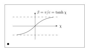
Los puntos de control de las dos curvas de Bézier se calcularon con las fórmulas (5.1). La rama positiva se determina con  $P_1 = (0; 0)$ ,  $m_1 = 1$  y  $P_2 = (2; \tanh 2)$ ,  $m_2 = 1/\cosh^2 2$ . De nuevo, el dibujo se define en coordenadas matemáticas convenientes, y a la esquina inferior izquierda se le asignan las coordenadas matemáticas (-3; -2) (círculo negro).
